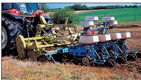
← **Des semoirs combinés.** Le semis est précédé d'un décompactage par lames souleveuses et d'un ameublissement par outil rotatif, soit en plein soit uniquement sur la ligne. Le sol est donc travaillé sur une profondeur de 5 à 25 cm selon réglages.
